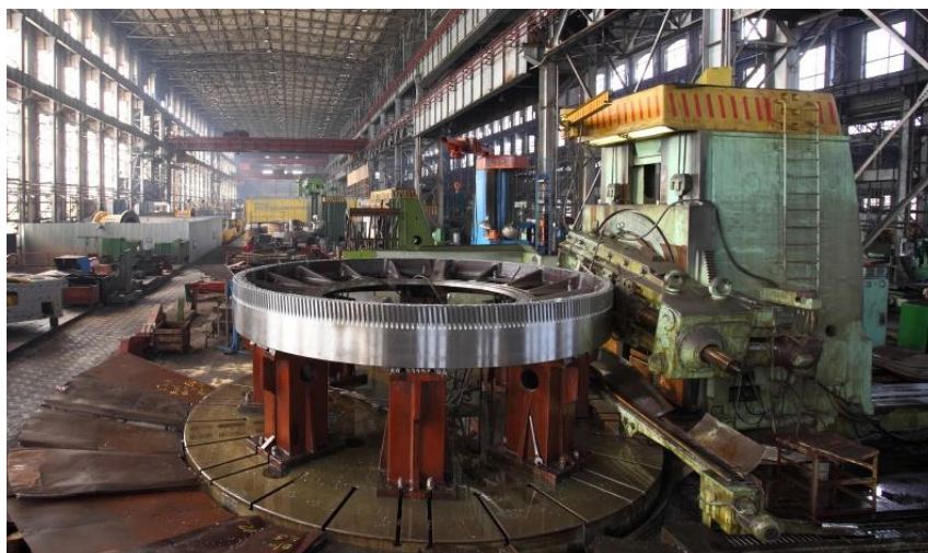
Сурет 3.2-КУ-306 тіс фрезерлік станогында тісті тәжді өңдеу
