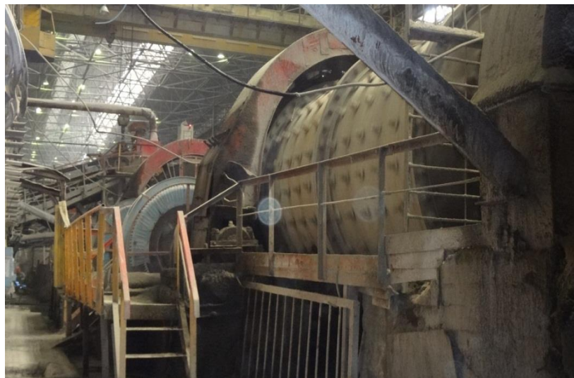
Сурет 1.4 –Балхаш кен-байыту фабрикасындағы шарлы диірмендермен жұмыс жасау участкесі
